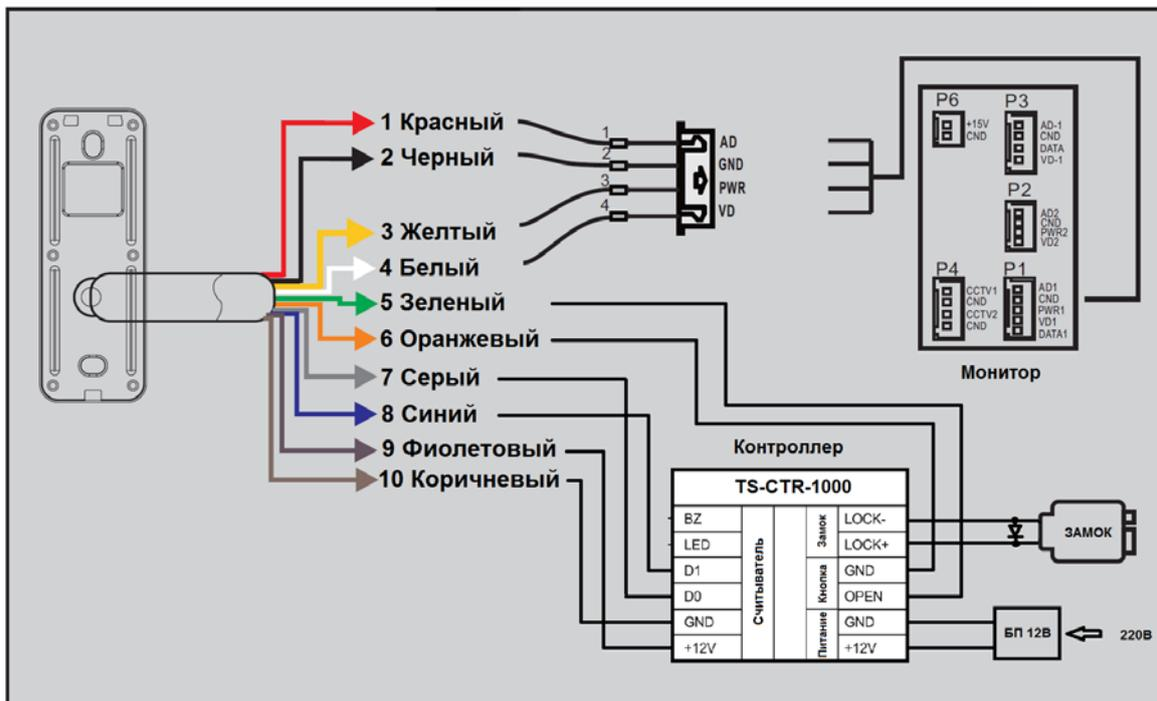
**Примечание:** Контроллер TS-CTR-1000 показан для примера. Считыватель панели может быть подключен к любому контроллеру, поддерживающему входной протокол формата Wiegand-26.
