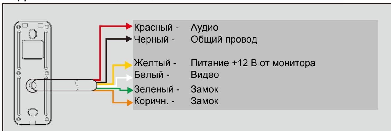
**Примечание:** Для управления замком используется нормально открытый электронный ключ с максимальным током 5 ампер. Для нормальной работы электронного ключа на контактах «Замок» должно присутствовать напряжение не ниже 4,5 вольт.
