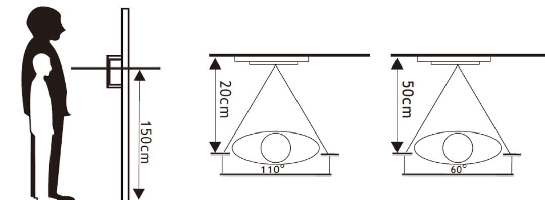
1. Выберите подходящее место для установки вызывной панели, избегайте попадания на панель прямого солнечного света, установки в темных местах, возможности заливания панели дождем.
