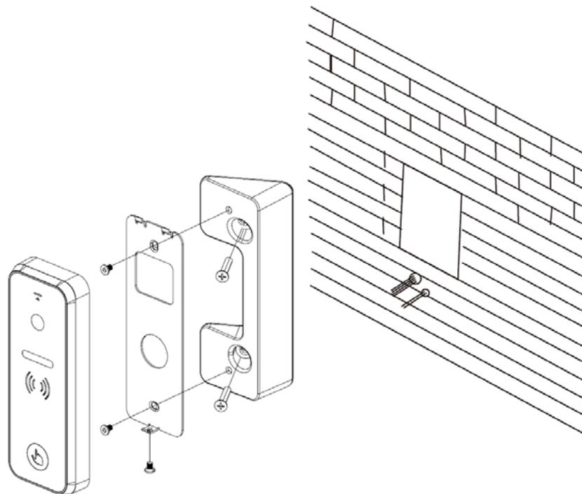
1. Просверлите отверстия в стене на нужной высоте.
