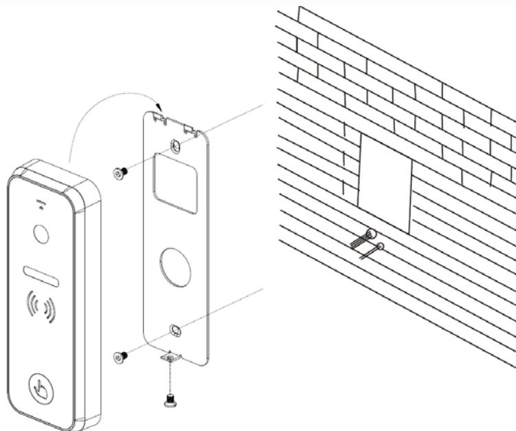
1. Просверлите отверстия в стене на нужной высоте.
