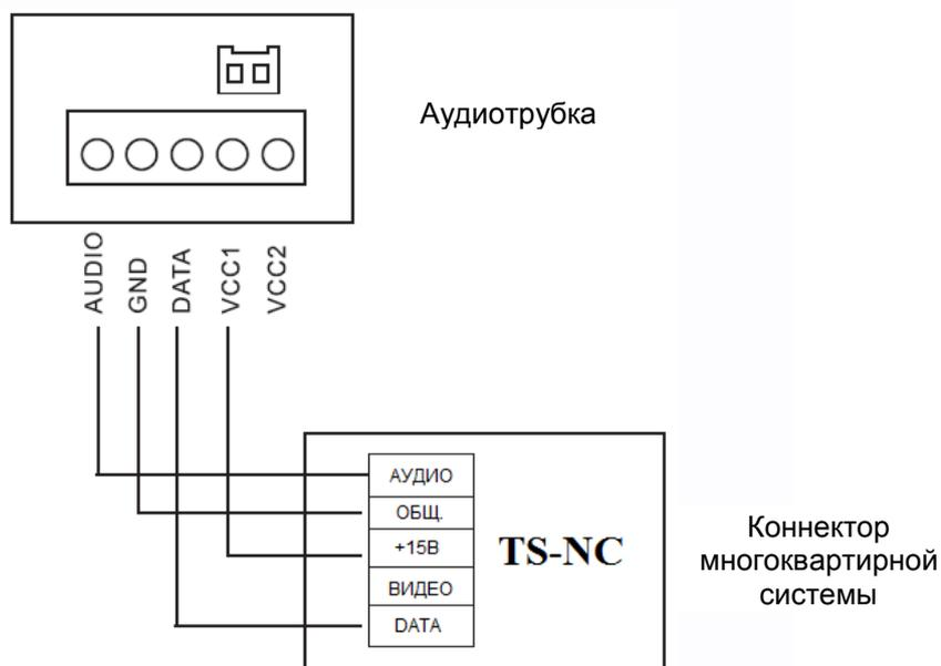
**Примечание:** При питании трубки от внешнего блока питания, подключение питания может осуществляться через коннектор питания или через клеммную колодку.
