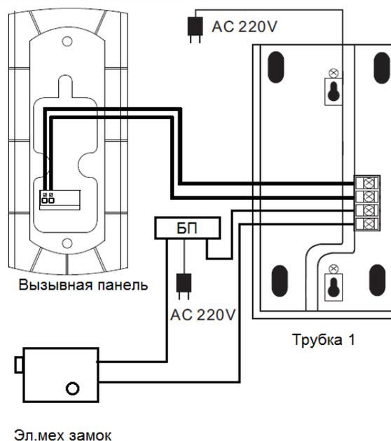
Схема подключения комплекта с одной дополнительной трубкой.
