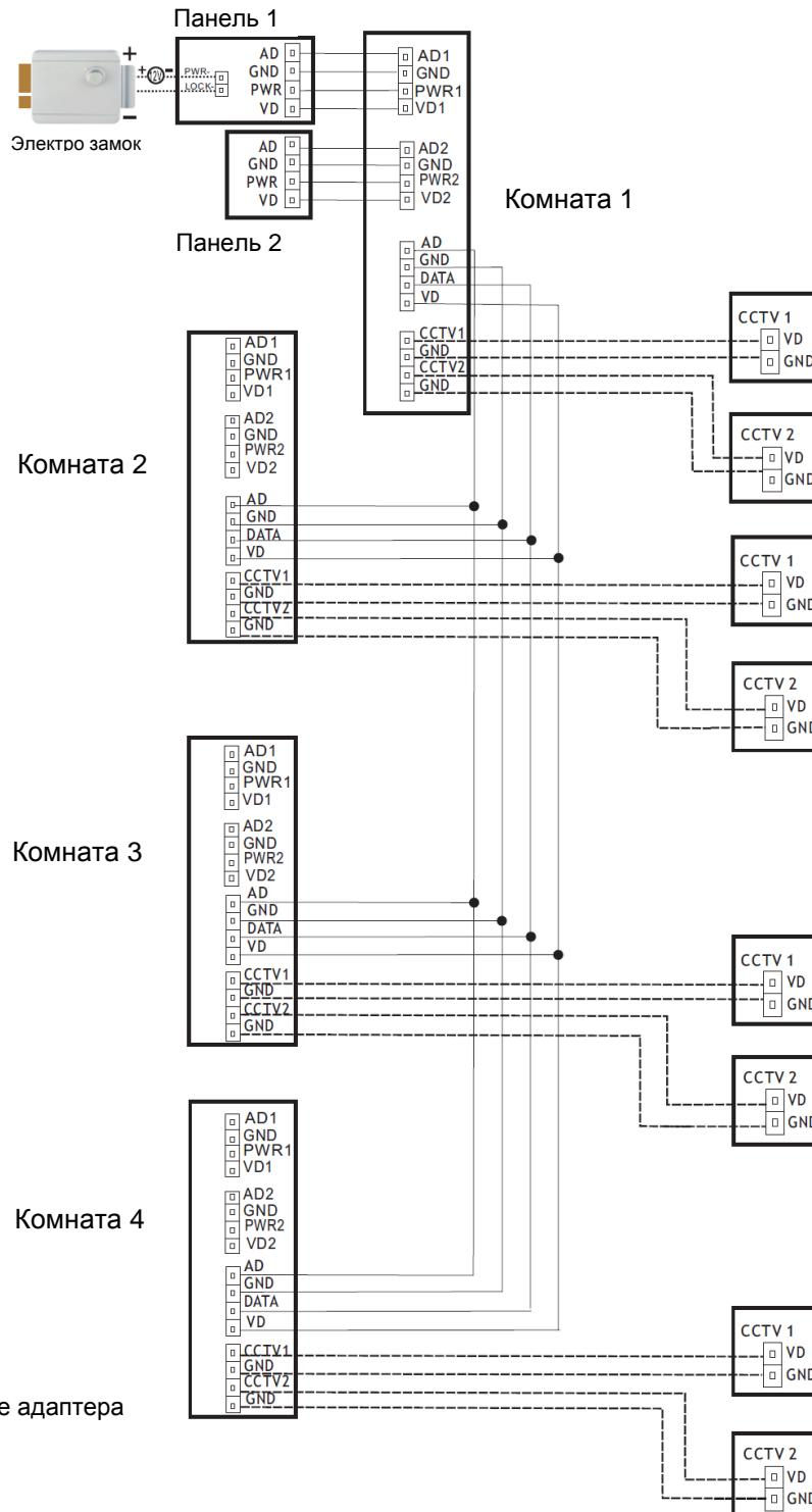
**Примечания:** На каждом мониторе можно видеть изображения только от камер, подключенных к нему (Если камеры подключены к порту вызывной панели основного монитора, их можно просматривать на всех мониторах).
