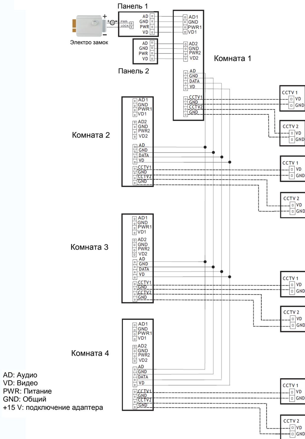
**Примечания:** На каждом мониторе можно видеть изображения только от камер, подключенных к нему (Если камеры подключены к порту вызывной панели основного монитора, их можно просматривать на всех мониторах).
