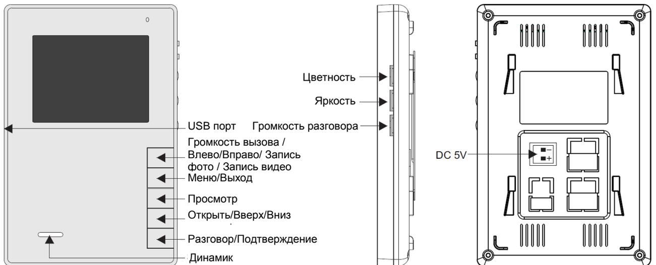
Примечание: Порт USB предназначен только для питания монитора
