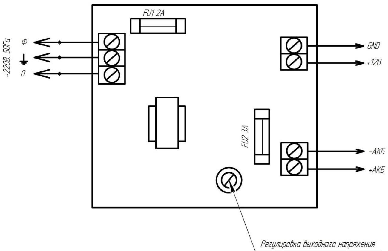
При длительном отключении ББП (более суток) и при снятом напряжении 220В, целесообразно отключить аккумулятор, сняв клемму «+».
